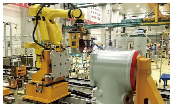
北自所为平高集团平芝公司建设的126千伏隔离开关智能化生产线
